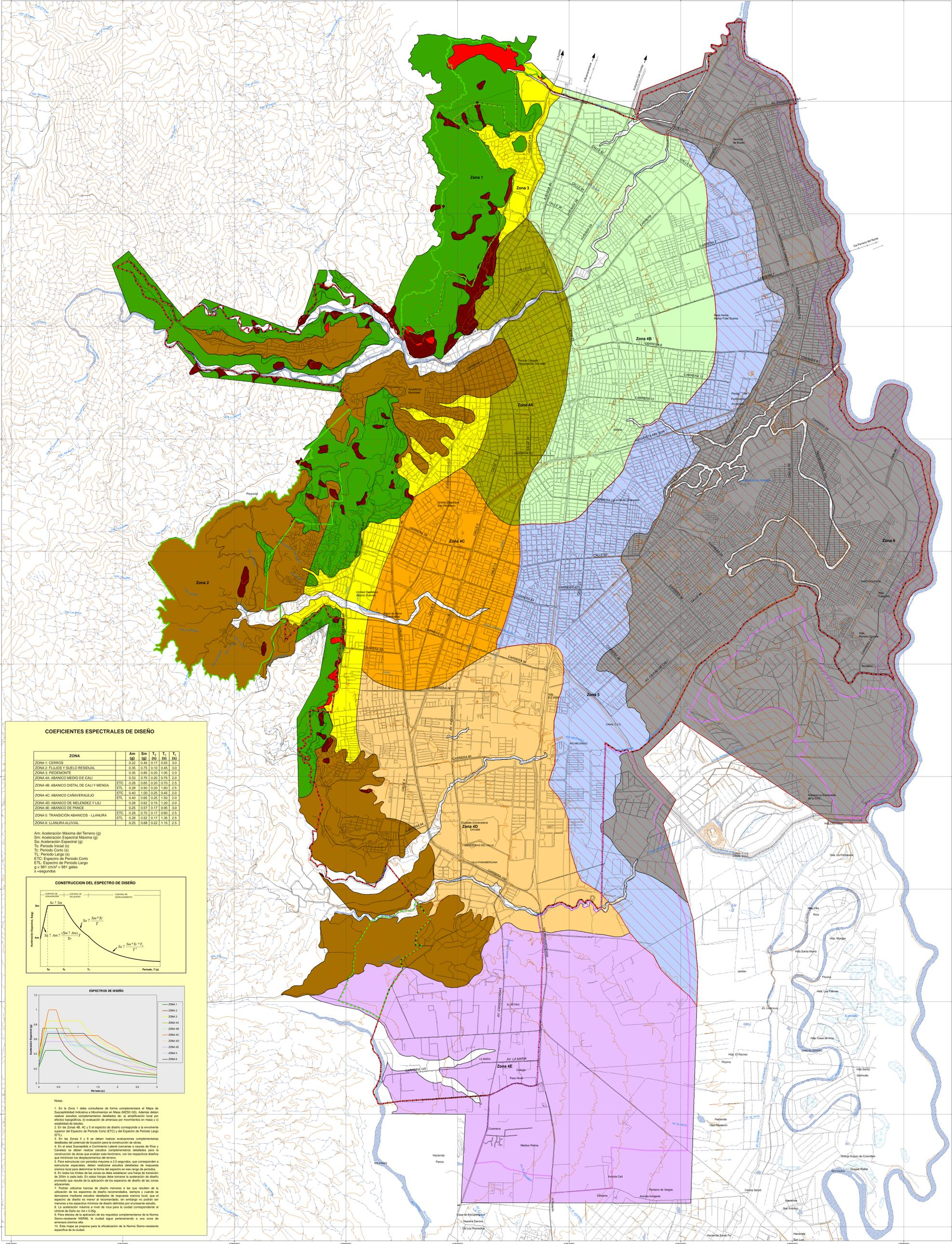
**COEFICIENTES ESPECTRALES DE DISEÑO**
